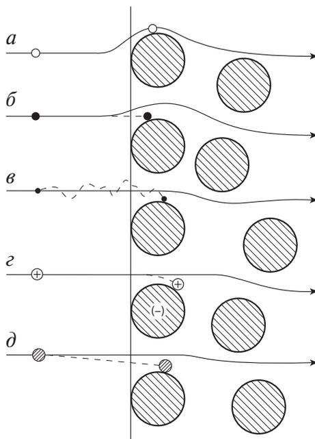
Рисунок 6. Схема действия различных эффектов осаждения аэрозольных частиц в волокнистом слое
